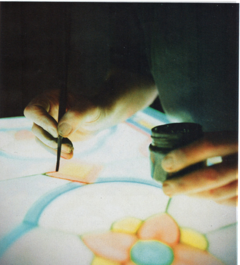
L'ART DU VERRIER. Hervé Debitus, à Tours, spécialisé dans la protection des vitraux comptabilise plus de 2500 m 2 de verrières thermoformées dans les plus grandes églises de France. Entre four, broyeurs à galets et cabine de sablage, il fabrique lui-même ses peintures à partir de pigments minéraux et d'oxydes métalliques.
